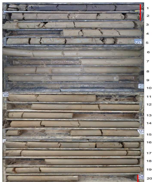
Fig.2.6. Coloane litologice – Forajul FG 01
