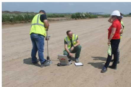
Fig. 6. Încercare în teren efectuată cu aparatul de solicitare dinamică prin șoc tip Zorn
